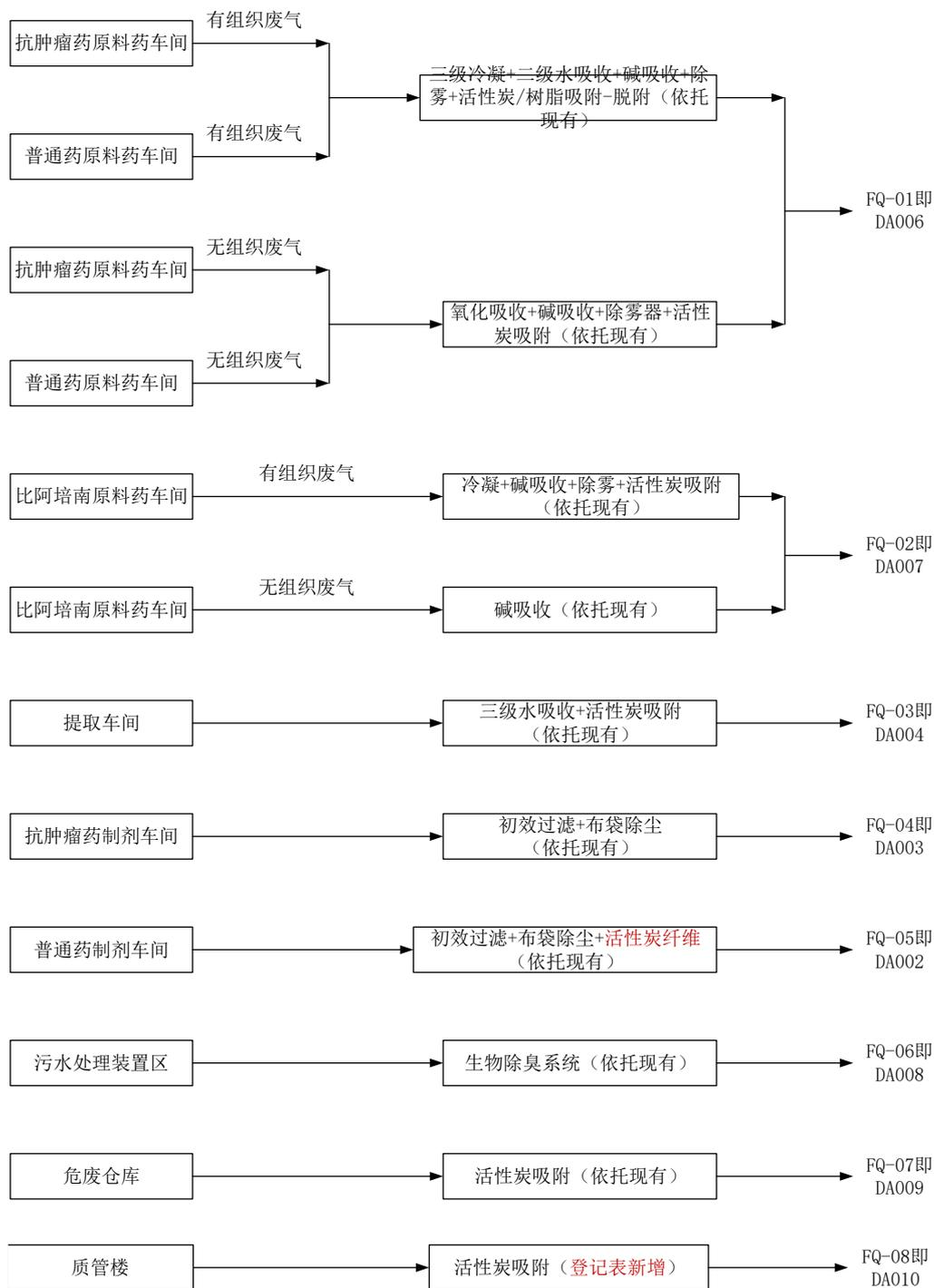
图 4.1-3 本项目废气处理工艺流程图
